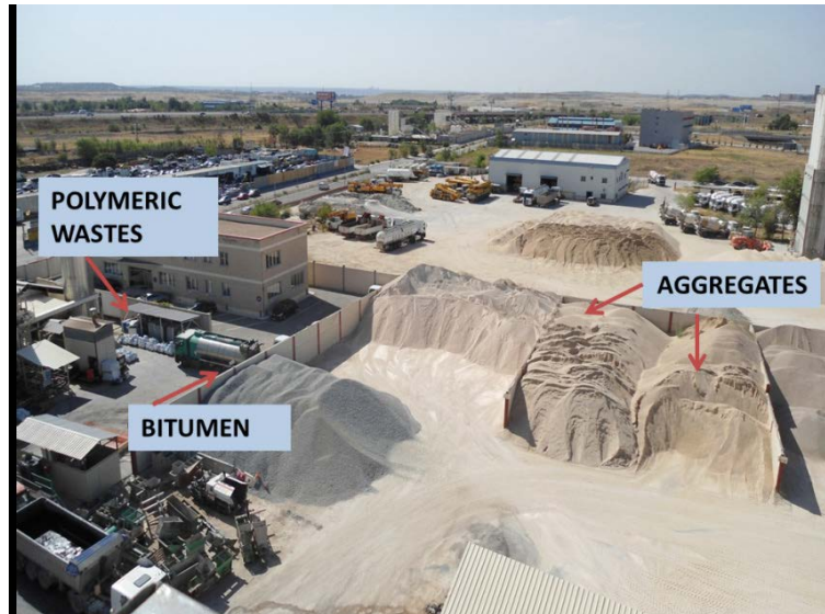
Figura 11. Almacenamiento en planta
