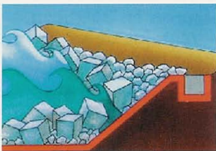
Fig. 5. Protección costera con geotextil
