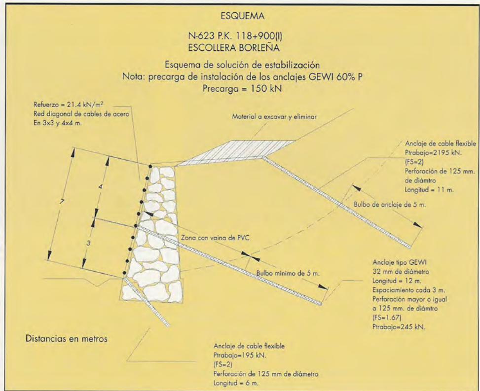
FIGURA 11. Esquema de la solución de refuerzo.
