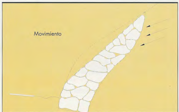
FIGURA 5. Esquema de fallo en un revestimiento de escollera.
