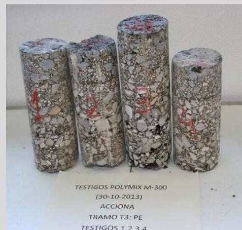
Testigos de las mezclas asfálticas del tramo experimental
